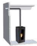
Zone 3 (terminal horizontal « ventouse »)
